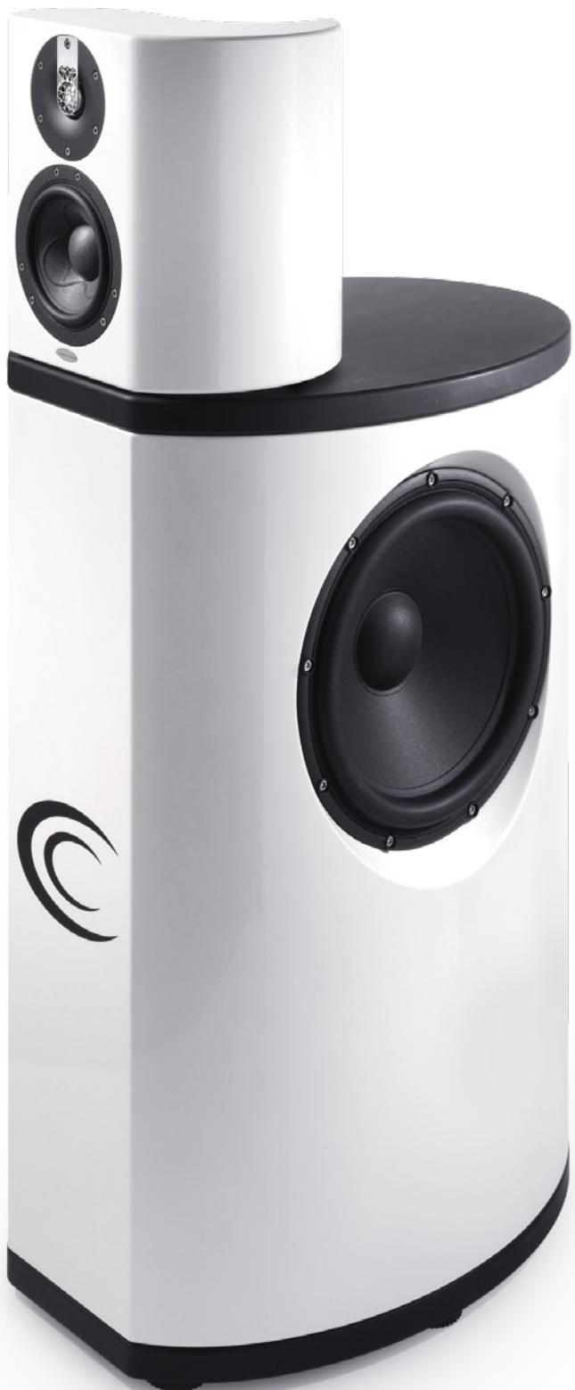
在Subissimo箱面作為一套使用的時候，只要拆除四隻小腳，便可以把AMD氣孔向下的透氣管道完全密封，再把Subissimo的分音頻率撥去70Hz@12dB或24dB/octave(或其他頻段，視乎房間的音響特性)，最後再仔細調校超低音的輸出電平，AMD便會搖身一變而成為頻應16Hz-50kHz，音效非常全面的揚聲器系統。
