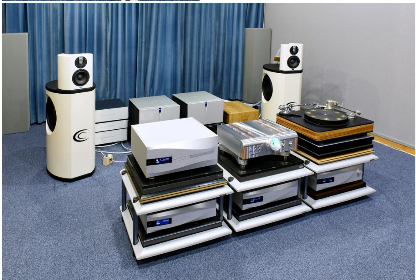
在本刊試音室這個面積比例和音響特性都頗為理想的聆聽環境，AMD+S這個喇叭組合確實令我有眼前一亮之感——想不到這個有點像猴子騎大象的喇叭系統看起來是如此順眼，而且放在試音室平時擺放喇叭的位置也有極高的融和感……先講配搭器材，它們包括dCS Vivaldi四件頭SACD/CD播放系統，Dan D'Agostino Momentum前級 + Audia Flight Strumento n°8單聲道後級推動AMD，Momentum前級的第二組pre-out以XLR平衡線直接驅動Subissimo，分頻點設定在70Hz@12dB/octave，音量掣在3點鐘位置，相位為0°，頗為容易便為這套AMD + S組合找到一個理想的擺位。其實為一些被動式喇叭加主動式超低音的喇叭組合調聲，最重要是調校全頻的連貫性，中低頻和低頻之間不能甩腳，但也不能過濃，超低頻有感覺便已經足夠，與家庭影院那種拳拳到肉式的狠勁低頻是南轔北轍的取向。
